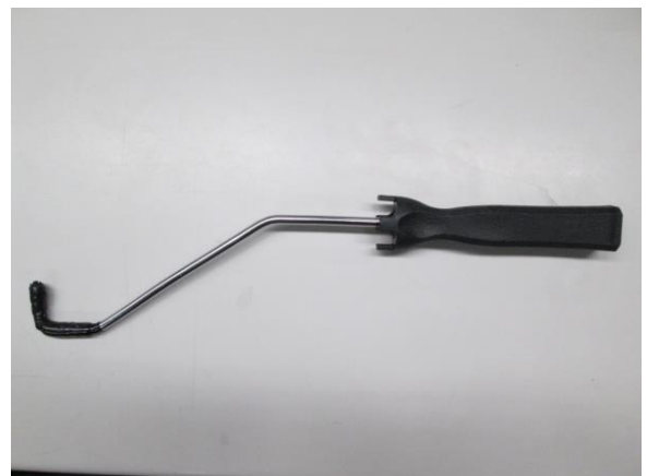
《Vベルトを交換するための工具「V-Exchanger（ベックス）」》
