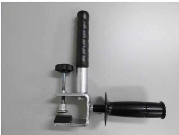
《Vベルトを交換するための工具「V-Exchanger（ベックス）」》
